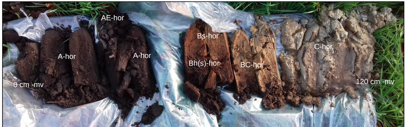
Figuur 5. Boorprofiel 4, de leesrichting is van links naar rechts (0 – 120 centimeter).
